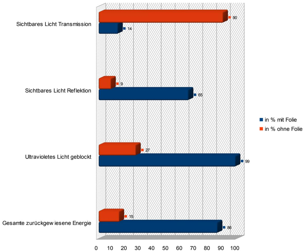
Ergebnisse basieren auf einer 4mm dicken Isolierglasscheibe.
